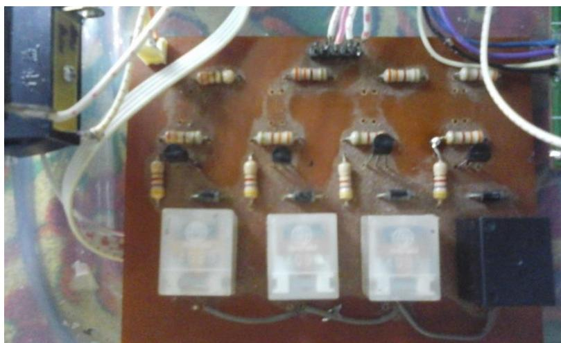
Gambar 18 Rangkaian Driver Relay
